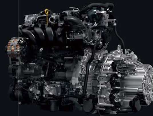
1.8L直列4気筒16バルブ直噴ターボエンジン
