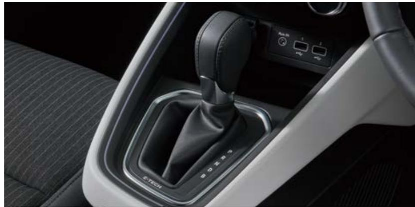
電子制御ドッグクラッチ マルチモードAT レザースhiftレバー
